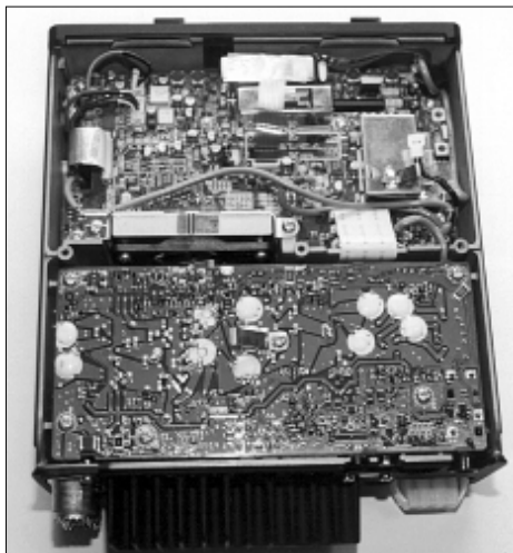
Das Innenleben des IC-706 MK IIG: Von beiden Seiten ist zu erkennen, daß er vollgepackt ist – es sind ja vier Transceiver Fotos: DH9JS
